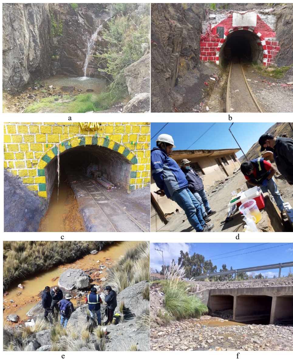
Figura 3. Muestreo Río Ichalaya y Mina Matilde – (a) Punto aguas arriba Río Ichalaya, (b) Salida de agua ácida Bocamina Maravilla, (c) Salida de agua ácida Bocamina Matilde, (d) Medición de parámetros Fisicoquímicos de aguas ácidas de Bocamina Matilde, (e) Muestreo en confluencia río Ichalaya Mina Matilde, (f) Muestreo Puente Chaguaya
